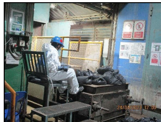
ภาพที่ 2.39 การปั๊มกากของเสียเข้า Riser Pipe
