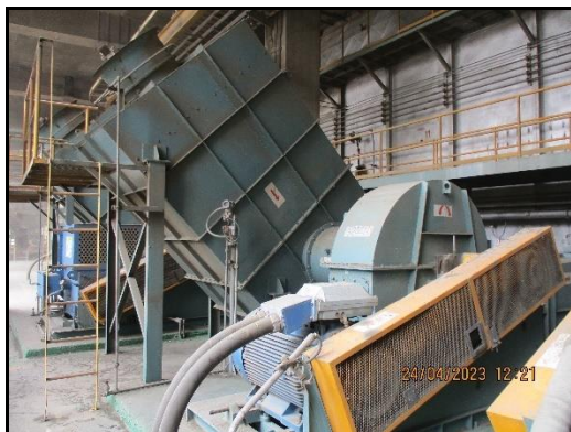
ภาพที่ 2.11 IKN Clinker Cooler
